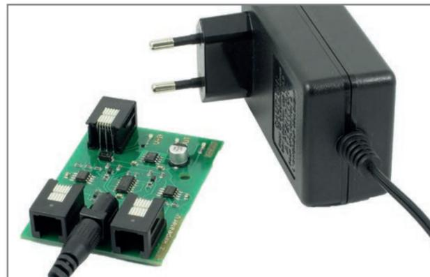
Bei großen Modulanlagen, z.B. bei Fahrtreffen, werden viele XpressNet-Geräte eingesetzt. Die Stromaufnahme der Geräte in der Summe übersteigt dann schnell das, was die Zentrale LZV100 zu versorgen in der Lage ist.
