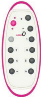
Fünf Digitalfunktionen können jetzt durch einen Tastendruck direkt geschaltet werden, weitere fünf durch zwei Tasten.
